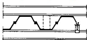
Stalowa rama prowadząca dla grodzic typu Z
